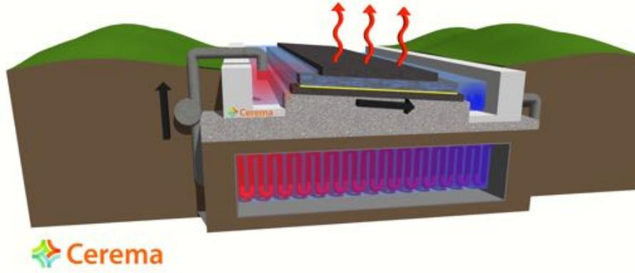
Figure 2: Schéma de principe de l'échangeur de chaleur (cas du chauffage).
