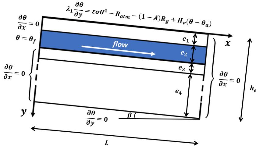
Figure 3: Schéma de la structure de chaussée avec les conditions aux limites ( $\theta_f$ ,  $\theta_a$  sont respectivement la température d'injection du fluide et la température d'air).
